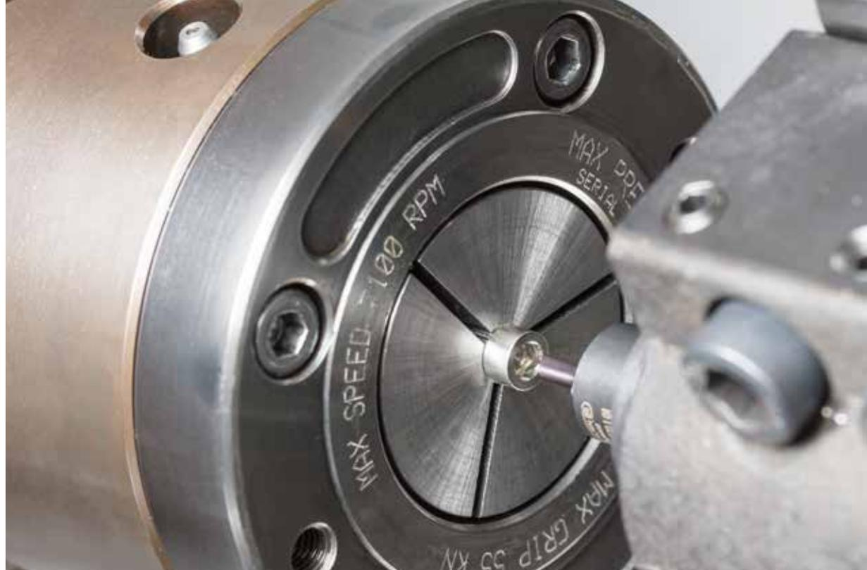
Stozzatura dell'esagono interno con il sistema Supermini N105.
