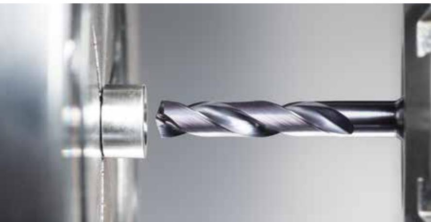
Foratura di una testa di vite con il sistema HORN DD.
