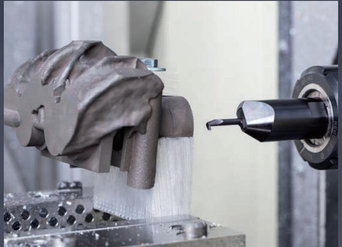
Finitura di una pinza del freno con un Supermini tipo 105.
