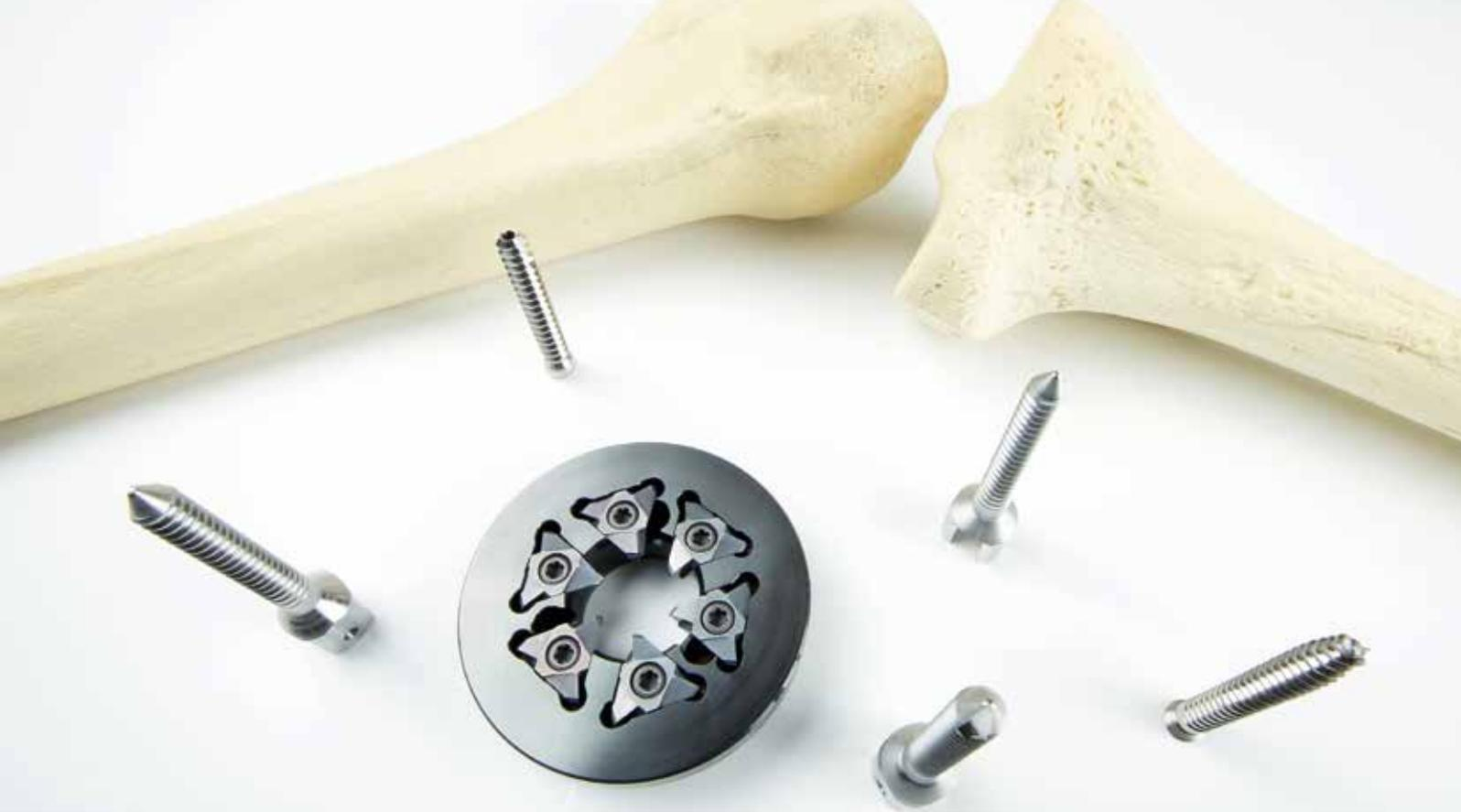
BU: Un'applicazione tipica dei sistemi medicali e la fresatura di viti per ossa.
