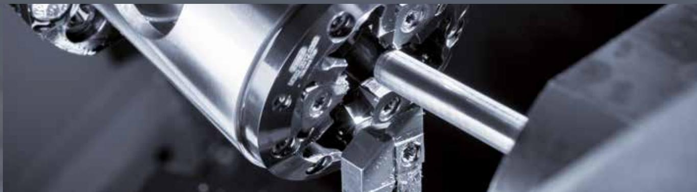
Utilizzo pratico della turbofresatura: Tornitura e fresatura in funzionamento parallelo.
