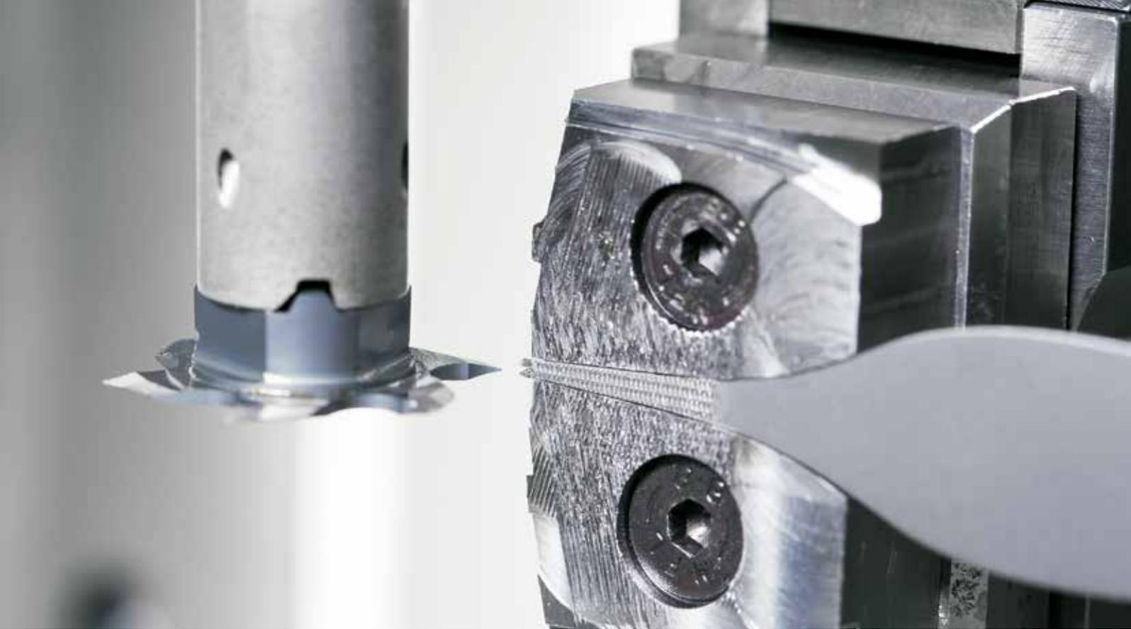
Intaglio della geometria del dente di topo “femmina”. L'angolo del fianco del profilo a 25°, 30° o 35° si basano sulla rispettiva altezza di profilo.
