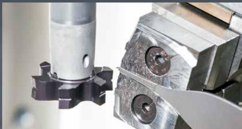
Fresature della geometria del dente di topo “maschile” con taglio posteriore a 5 assi. L'angolo di base della geometria del dente è limitato a massimo 3/100 mm.
