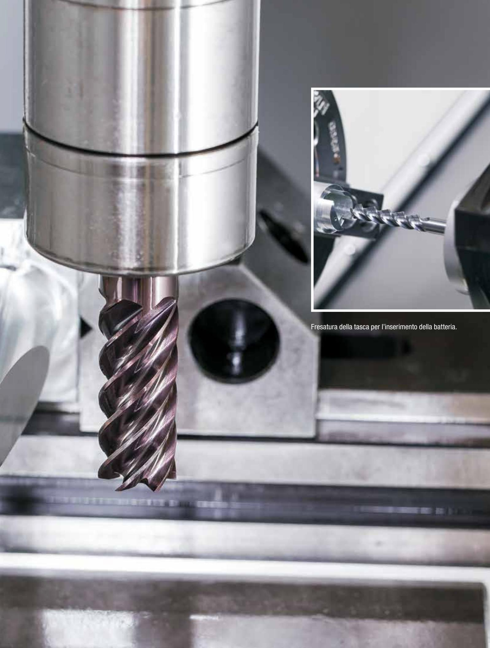
Fresatura della tasca per l'inserimento della batteria.
