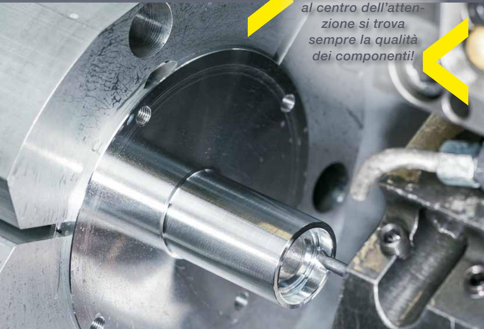
Tornitura del diametro interno con il sistema Supermini, tipo 105.
