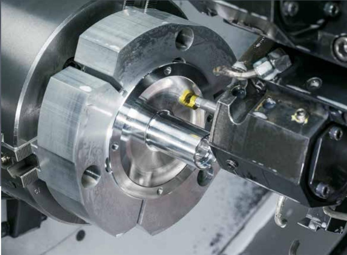
Finitura della superficie esterna del piccolo diametro e della superficie piana concava con l'utensile da taglio assiale del tipo mini R114.
