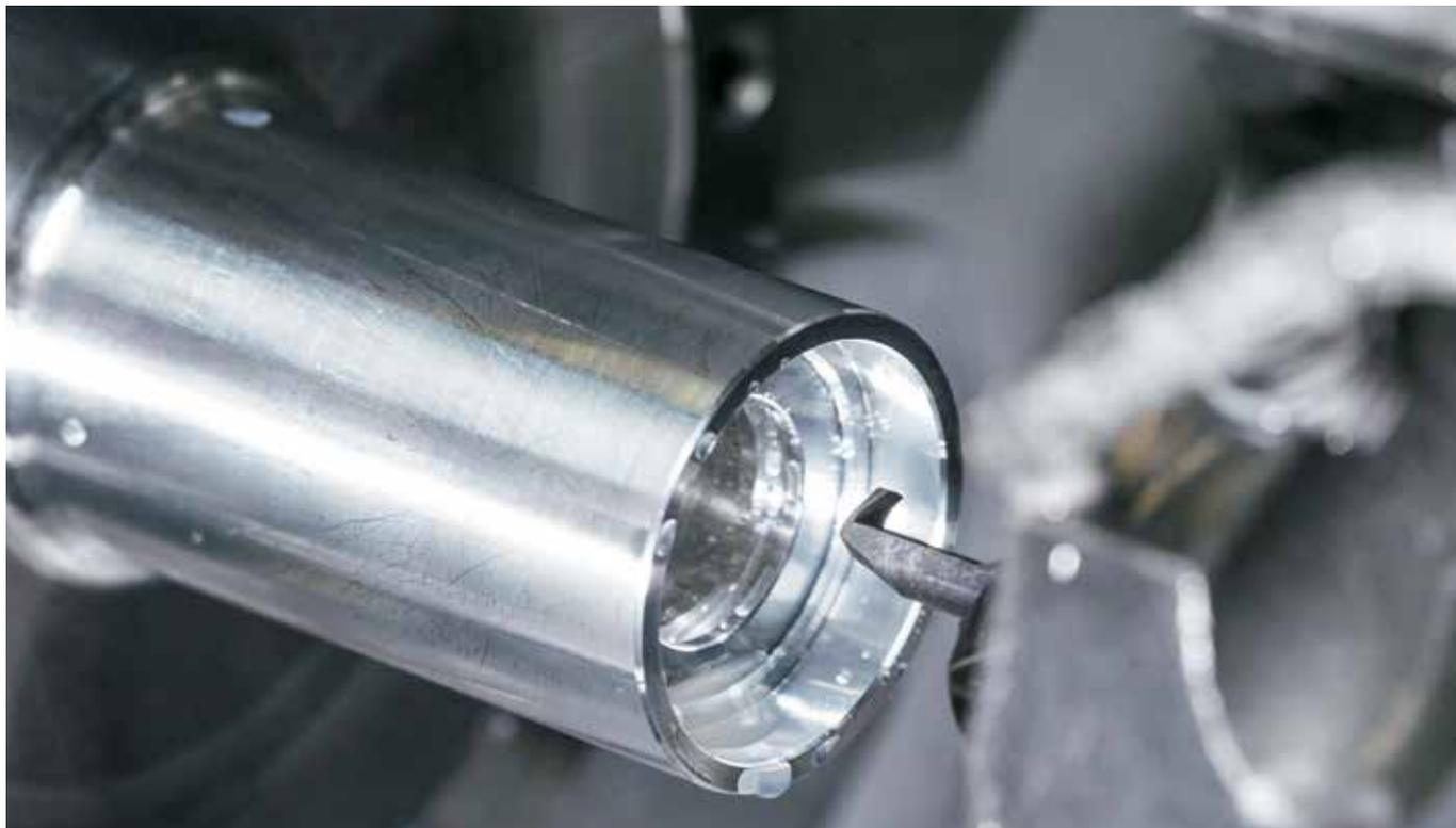
Supermini tipo 105 nella lavorazione della gola di scarico interna da 1 mm di larghezza.
