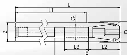
• **Di norma:** Ghiera di serraggio di alta precisione MPC **senza** collassabilità. Concentricità di  $\leq 3 \mu\text{m}$  con le pinze di serraggio GERC-HP.
