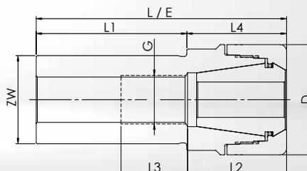
• **Di norma:** Ghiera di serraggio di alta precisione DPC **senza** collassabilità. Concentricità di  $\leq 3 \mu\text{m}$  con le pinze di serraggio GERC-HP.
