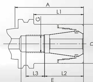
• **Corpo del mandrino e ghiera di serraggio sono bilanciate separatamente a** G2.5 a 25.000 giri/min o  $\leq 1$  gmm
