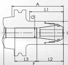
• **Corpo del mandrino e ghiera di serraggio sono bilanciate separatamente a** G2.5 a 25.000 giri/min o  $\leq 1$  gmm
