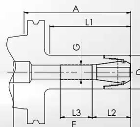
• **Corpo del mandrino e ghiera di serraggio sono bilanciate separatamente a** G2.5 a 25.000 giri/min o  $\leq 1$  gmm
