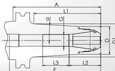
• **Corpo del mandrino e ghiera di serraggio sono bilanciate separatamente a** G2.5 a 25.000 giri/min o  $\leq 1$  gmm
