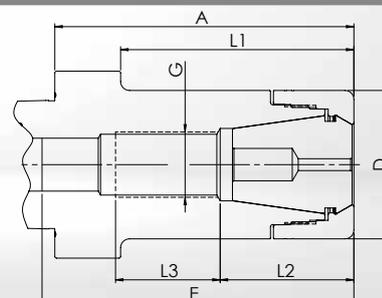
• **Corpo del mandrino e ghiera di serraggio sono bilanciate separatamente a G2.5 a 25.000 giri/min o  $\leq 1$  gmm**
