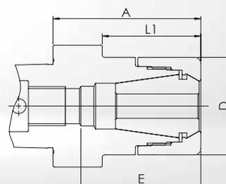
• **Corpo del mandrino e ghiera di serraggio sono bilanciate separatamente a G2.5 a 25.000 giri/min o  $\leq 1$  gmm**
