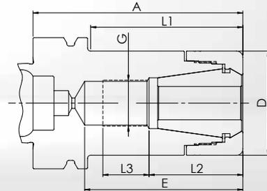
• **Corpo del mandrino e ghiera di serraggio sono bilanciate separatamente a** G2.5 a 25.000 giri/min o  $\leq 1$  gmm
