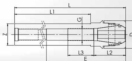
• **Di norma:** Ghiera di serraggio di alta precisione DPC **senza** collassabilità. Concentricità di  $\leq 3 \mu\text{m}$  con le pinze di serraggio GERC-HP.
