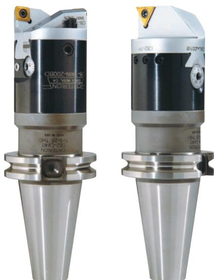
Allied Criterion è uno dei sistemi a barenare modulari registrabili più completi sul mercato, coprendo una gamma di diametri da 3.0 mm a 341.00 mm con microregistrazione di 0.0012 mm sul diametro. Prodotto in acciaio legato di prima scelta, Allied Criterion offre sistemi a inserto singolo o doppio con ampia flessibilità sulla lunghezza, il diametro e l'attacco, utilizzando inserti ISO standard.
