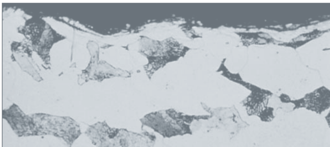
Ingrandimento di un pezzo rettificato con Ra=1 micron
