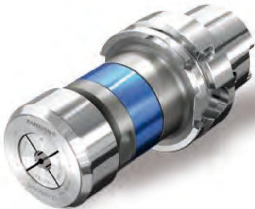
Il portautensile per filettare SYNCHRO|T serve a compensare tutte quelle differenze di passo tra il mandrino della macchina utensile ed il pezzo, così come le differenze sull'utensile maschiatore. Si utilizza pertanto sui Centri di Lavoro nelle operazioni di maschiatura rigida.
