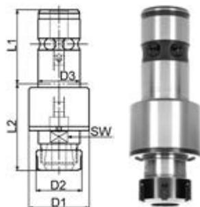
Attacchi flottanti PE-ER per pinze di serraggio DIN ISO 15488 (ER/ESX)
